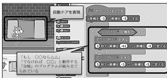
図9 「分岐」の動作がプログラムされた「スクリプトパック」(研究協力校Bで活用したもの)
